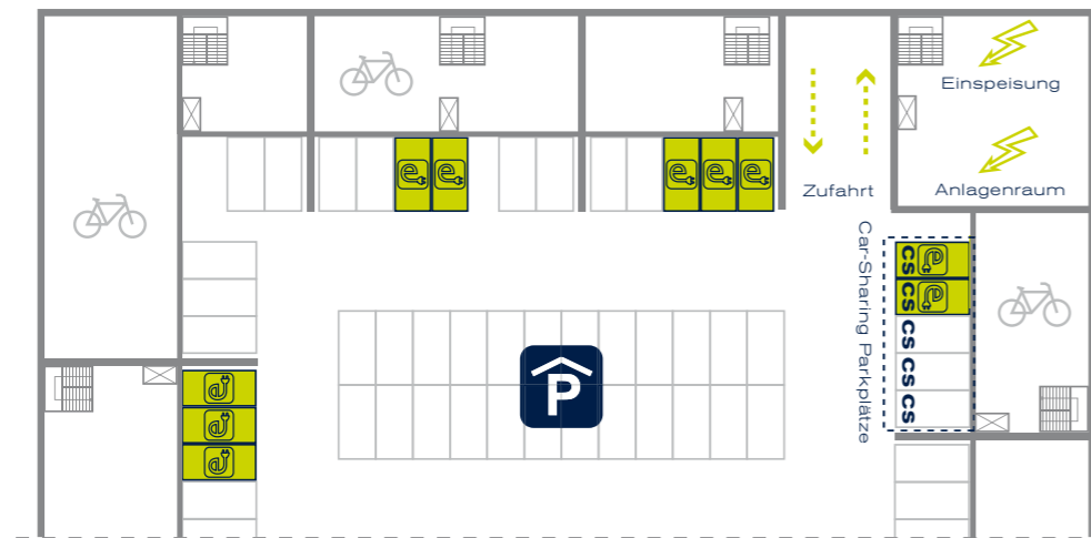
Abbildung 38: Tiefgaragengrundriss mit zehn Ladestationen und Car-Sharing-Parkplätzen (Szenario 2015)
