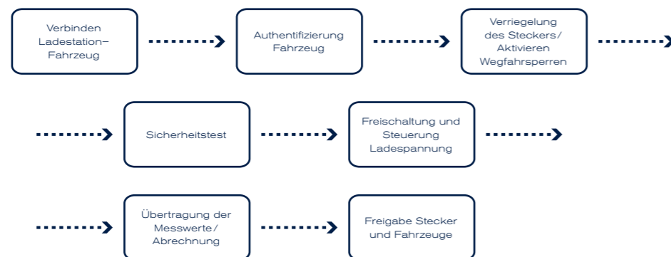
Abbildung 13: Idealer Ladevorgang eines Elektrofahrzeugs (mit Mode 3)
