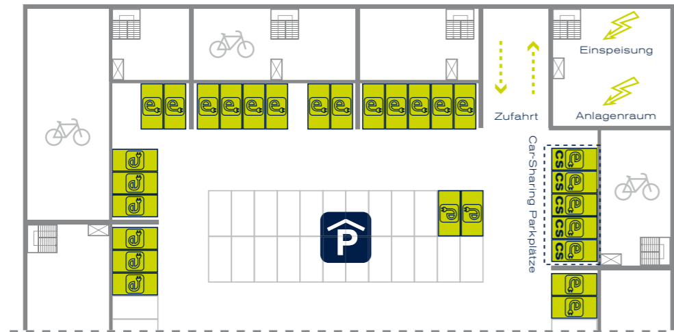
Abbildung 39: Tiefgaragengrundriss mit 30 Ladestationen und Car-Sharing-Parkplätzen (Szenario 2030)
