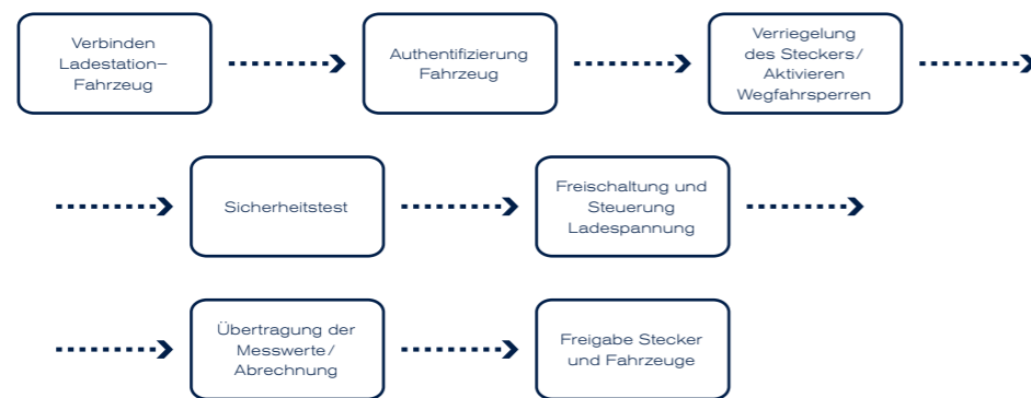
Abbildung 13: Idealer Ladevorgang eines Elektrofahrzeugs (mit Mode 3)
