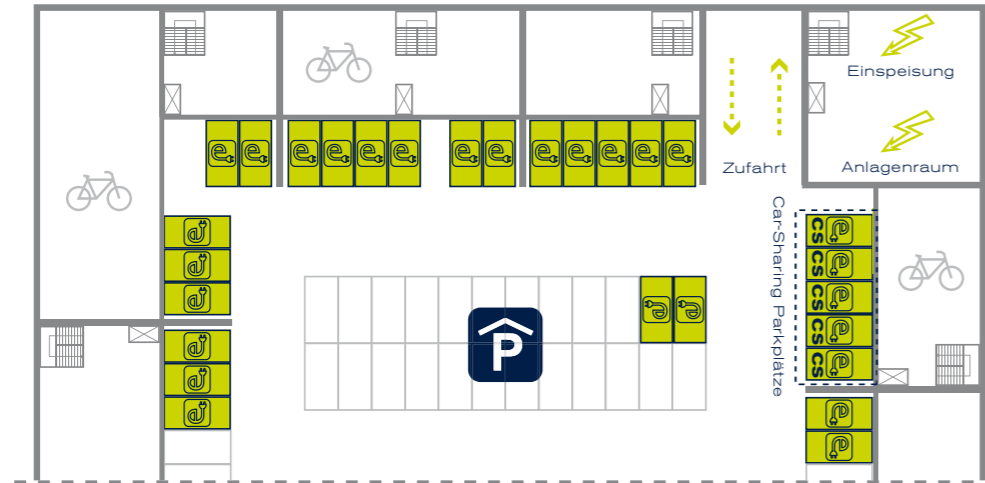
Abbildung 39: Tiefgaragengrundriss mit 30 Ladestationen und Car-Sharing-Parkplätzen (Szenario 2030)
